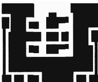
VHF/UHF antena analajzer. Delovi se leme na strani bakra
